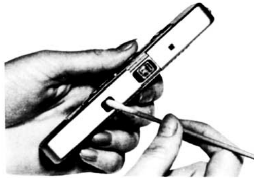
Objektivfenster mit Wattestäbchen reinigen – oder mit sauberem Läppchen (um ein Streichholz wickeln).
